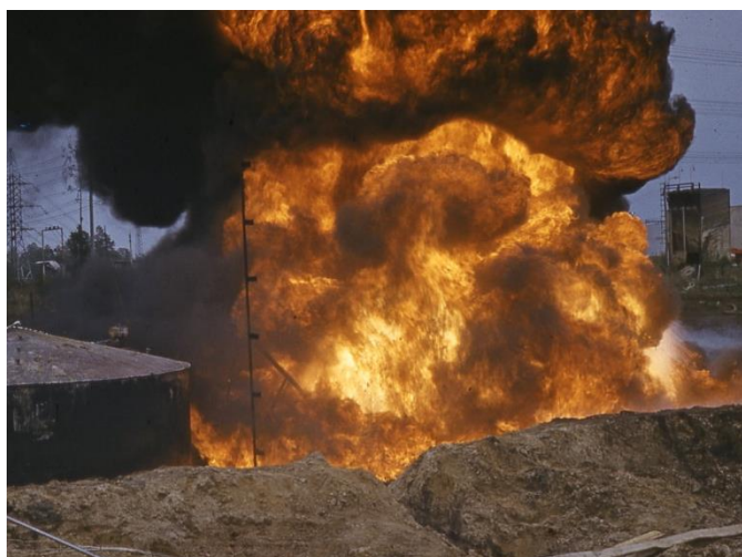
Рис. 9.1. Экспериментальные исследования, проведенные Академией ГПС МЧС России, по изучению пожарной опасности резервуара в условиях пожара
