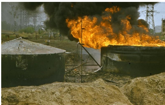
Рис. 4.2. Экспериментальные исследования, проведенные Академией ГПС МЧС России, по изучению пожарной опасности резервуара, расположенного рядом с горящим резервуаром
