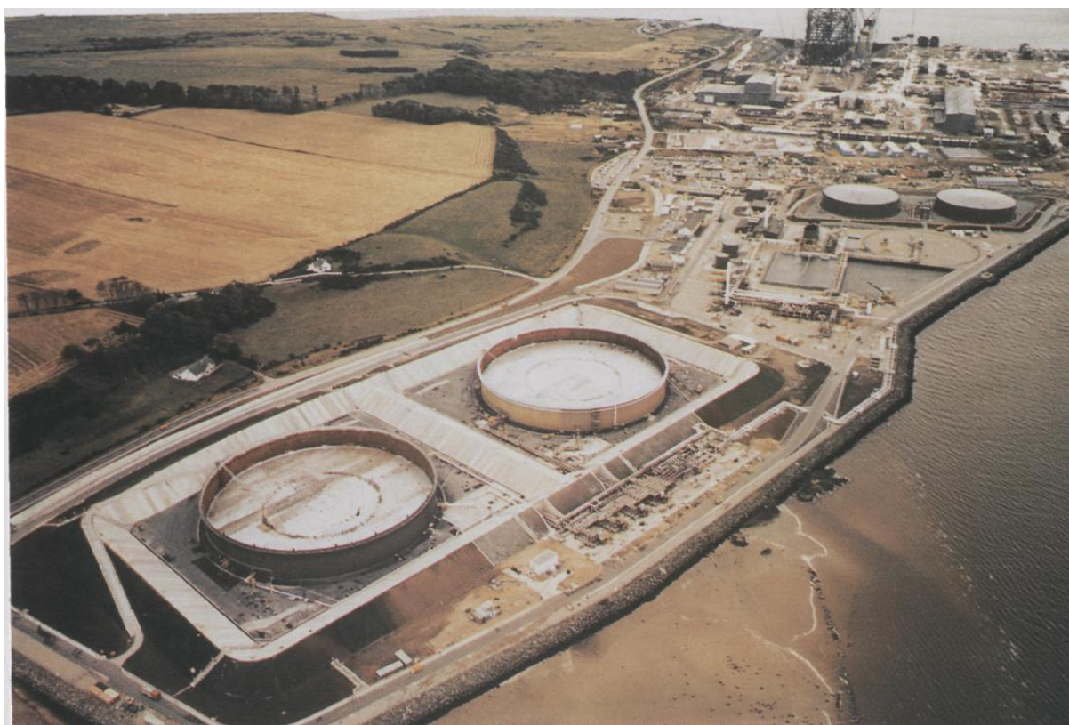
Рис. 1. Резервуары с плавающей крышей
